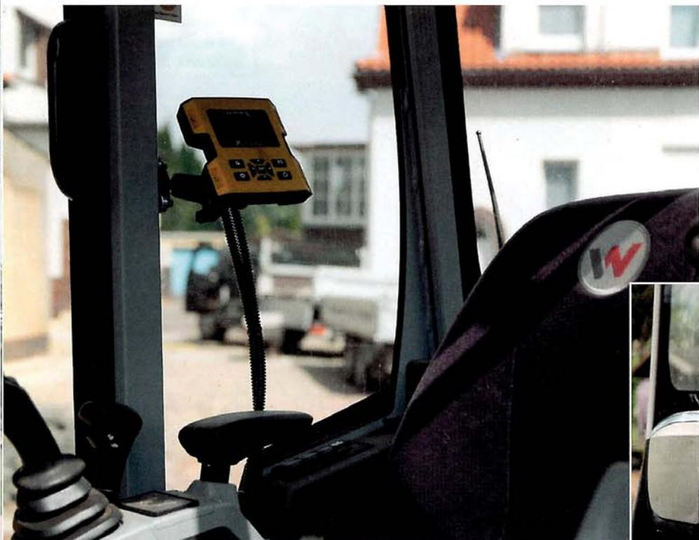
Xsite® Easy von MOBA holt quasi Wasserwaage und Zollstock in die Fahrerkabine. Das System ermöglicht eine einfache Planumstellung ohne Absteckungen und spart Zeit bei der Höhen- und Neigungskontrolle.
