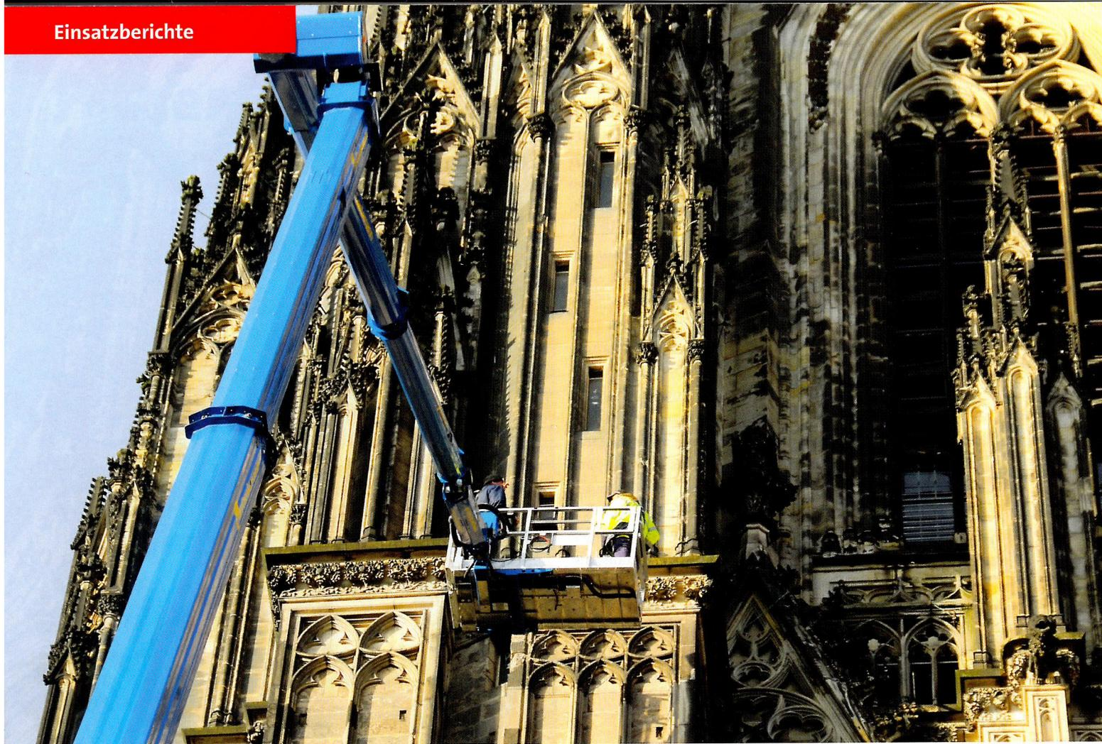
Der Korb lässt sich mithilfe der neuen Steuerung zentimetergenau bewegen und positionieren, sodass alle kritischen Punkte am Dom sicher umfahren werden können.
