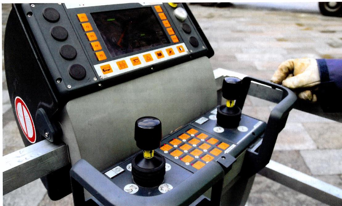
Das Bedienpult der Lkw-Arbeitsbühne GL 540 DHK-R mit seinen ergonomischen Bedienelementen.
