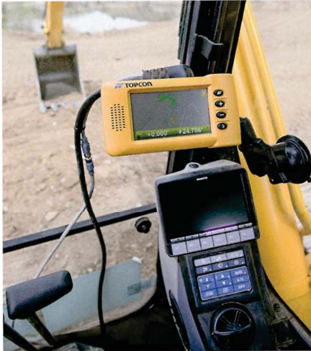
Baustelle und Löffel immer im Blick: Das System x-33 ist eine leistungsfähige, aber einfach bedienbare Baggersteuerung. (Bild: Topcon)
