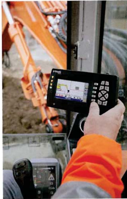
Mit dem System GCSFlex+GPS lassen sich die Baustellendaten direkt am Einsatzort erstellen. Die Steuerung zeigt später im Baggermodus die Soll-Linien des Bauwerks. (Bild: Trimble)
