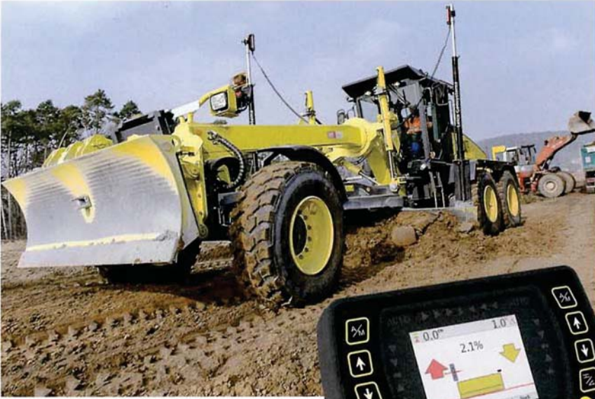
Günstiger und bei Bedarf auch hochrüstbarer Einstieg ins Graden mit Maschinensteuerung: das einfach bedienbare 2D-System iCon grade iGx2. (Bild: Leica Geosystems Schweiz)
