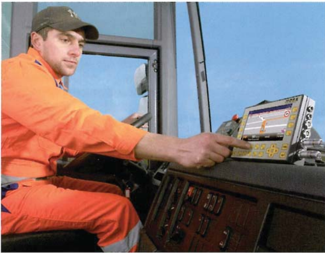
Der Bordcomputer kann nicht nur zur Anzeige der Adress- und Leerungsdaten, sondern beispielsweise auch zur Navigation verwendet werden
