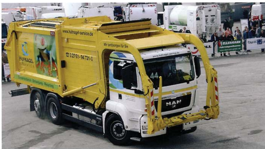
Der Frontlader »EHP 7000« von Heil aus den USA, den Schmidt Kommunalfahrzeuge in Deutschland vertreibt. Der Aufbau fasst 34 Kubikmeter Abfall.
