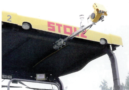
Bild 2: Erstmals wird auch ein Temperaturprofil mittels Temperaturscanner mit erfasst
